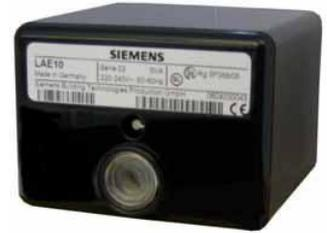
バーナ・ファン、イグニッション、燃料弁、エア・ダンパ等をシーケンス制御してプログラム着火する場合にはLEC1自動着火シーケンサーとバーナの数に応じたLAE10を組合せて使用します。自動着火シーケンサーLEC1につきましては別途技術資料をご参照願います。バーナを連続的に24時間以上燃焼運転する場合は、セルフ・チェックング・プログラム・コントロール・システムLFE50を使用して下さい。
